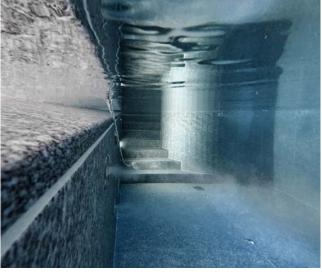
Das Becken ist auf zwei Seiten mit einem freien Überlauf konstruiert. Das Wasser läuft dekorativ über die Kante in die tieferliegende Rinne.
